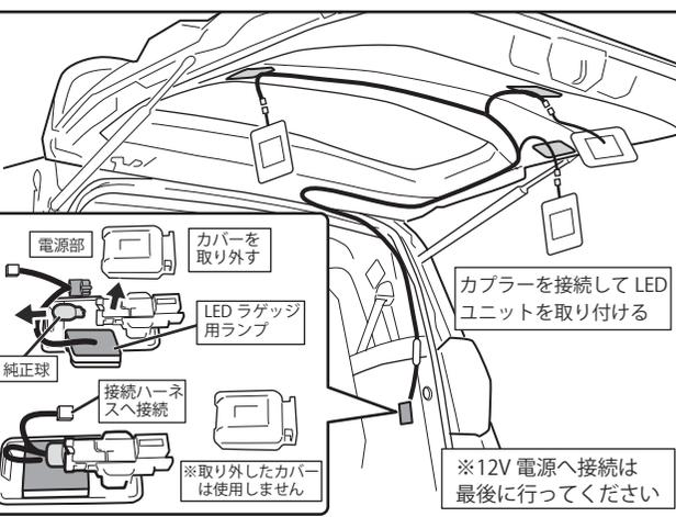
後席ラゲッジランプを車体から取り外し、電源カプラーを外します。サイドパネルを固定ボルトを外します。
