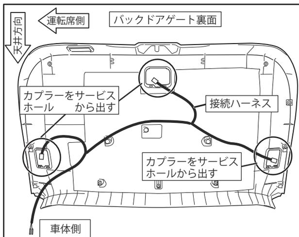
上記図のように配線をしてください。誤って中間カプラーの接続ピンを取り付けた場合は「コネクターピンの外し方」を参照してピンを抜いてください。
